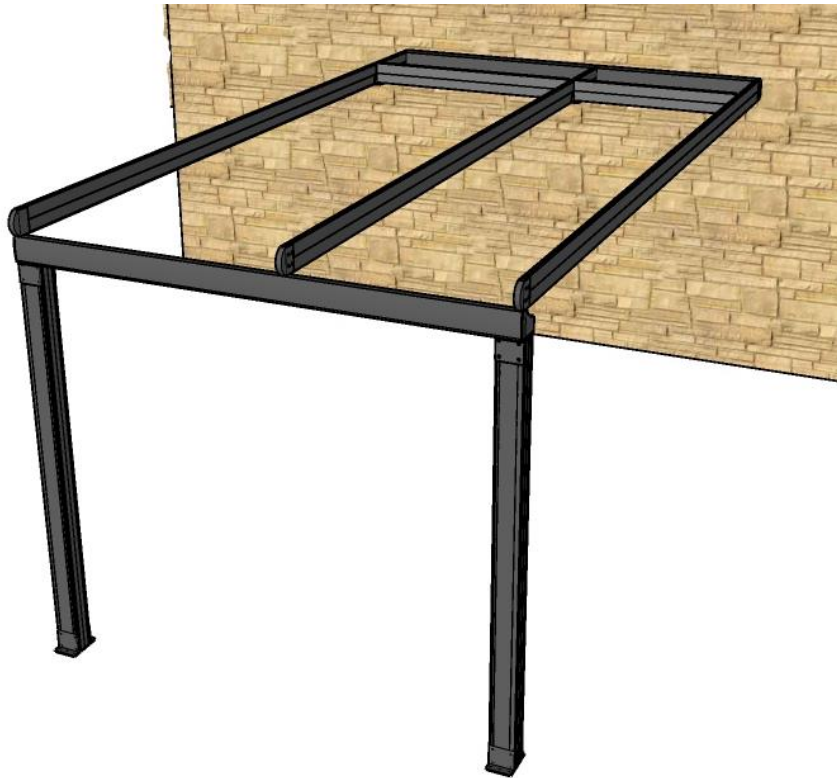
8. Vista oblicua superior. Instalación estructura principal.
